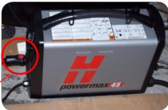
conexiones de antorcha y tierra aseguradas en sitio
