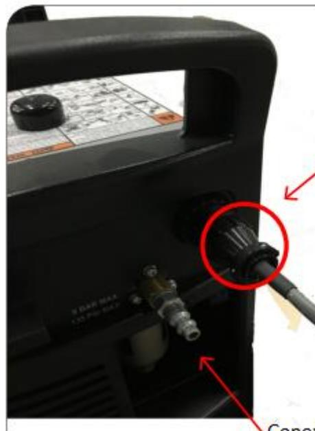
Cable de control que viene de la caja controladora
