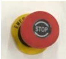
I.3.2. Arranque y parada. Prende y apaga la máquina siempre que ésta tenga alimentación eléctrica
