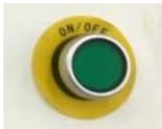
I.3.3. Luz indicadora de potencia eléctrica. Encendida indica que la máquina está alimentada.
