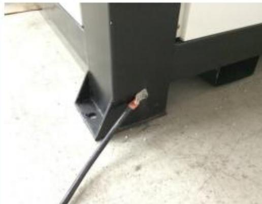
Asegúrese de que la plasma CNC está bien aterrada. Utilice la conexión para este fin ubicada en la parte trasera de la máquina.
